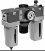
필터 + 레귤레이터 + 루브리케이터 필터 여과도 5 \mu 표준사양, 취부용 T-브라켓 포함
